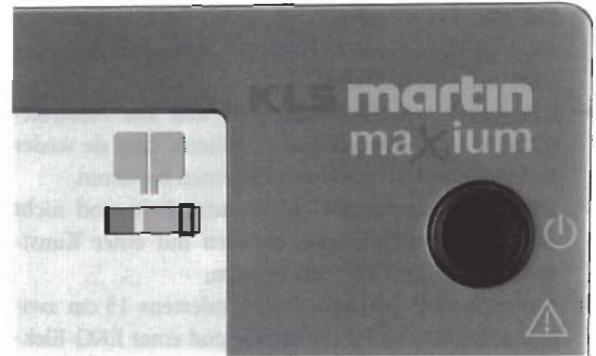
■ Abb. 28.15. Kontinuierliche Statusanzeige über die Anlagequalität der geteilten Neutralelektrode
