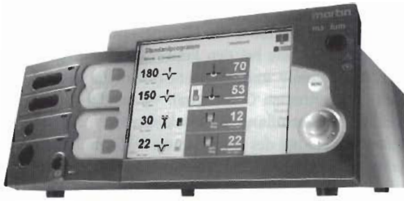
■ Abb. 28.2. Modernes HF-Chirurgiegerät mit menügeführter Bedienoberfläche. Die Behandlungsparameter sind auf einem Bildschirm räumlich dem jeweiligen Patientenausgang zugeordnet
