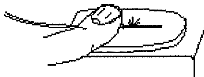
Abb. 13.3 Pilotlaserkontrolle der gekerbten Faser
