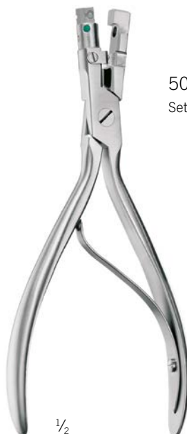
50-502-10-07 Pinza multifunzione 16 cm/6 1/4" per sistemi da 1,0/1,5/2,0 mm con funzioni di piegatura 3D, piegatura a 90° e taglio
