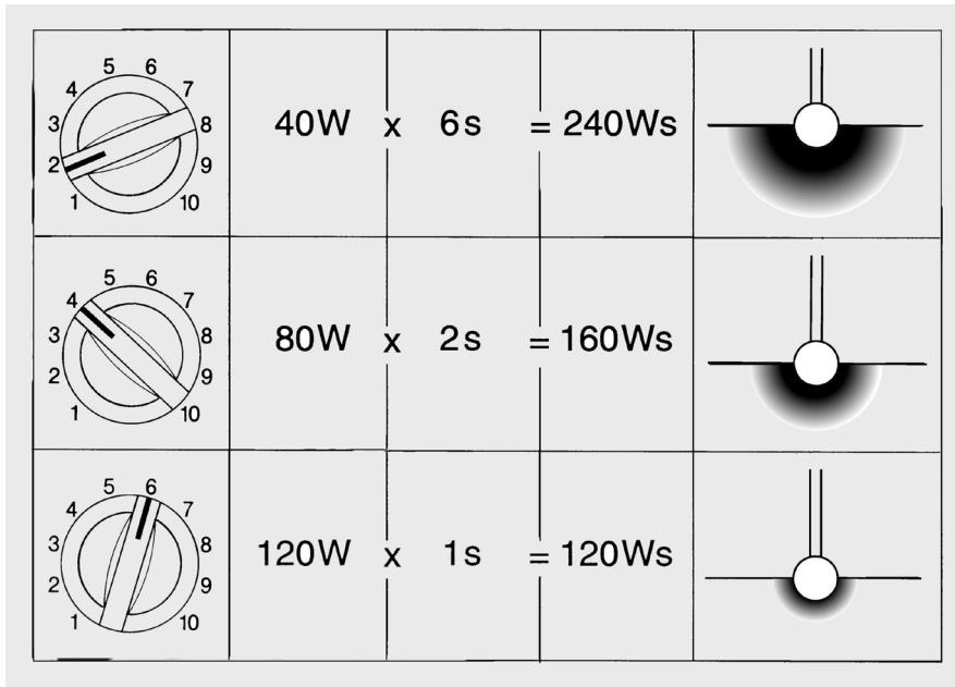
Hier sind die Auswirkungen des Grundlagengesetzes der Joulschen Wärme auf die Handhabung eines HF-Gerätes symbolisch dargestellt. Hierbei gilt, dass die erzeugte Wärmemenge abhängig ist von
