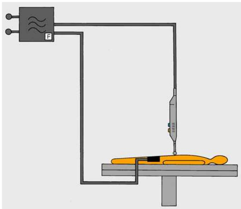
Bei der monopolaren Anwendungstechnik erfolgt ein Stromfluss von der Aktivelektrode durch das biologische Gewebe zur Neutralelektrode. Der HF-Generator dient hierbei als Spannungsquelle für den hochfrequenten Strom. Durch die Zuleitung zum chirurgischen Handgriff, zur Aktivelektrode und zum Patienten sowie zur Neutralelektrode und deren Anschlusskabel wird der elektrische Stromkreis geschlossen.
