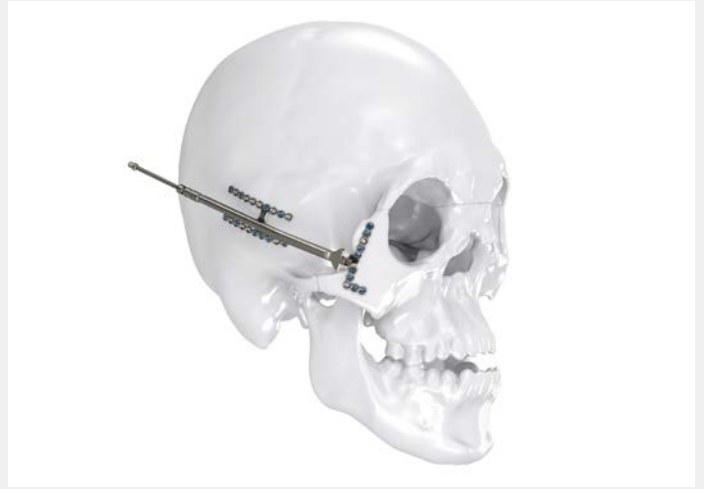
Distração bilateral da face média Distrator Kawamoto específico do paciente com placas de fabricação individual. Fixação com parafusos padrão de 1,5 mm.
