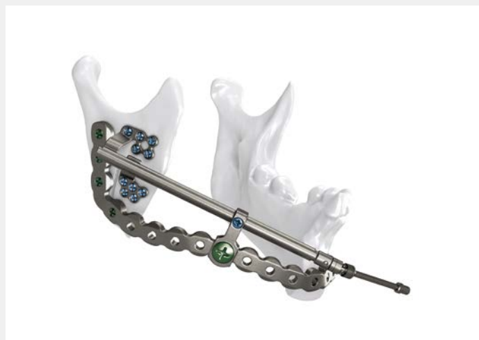
Distração de transporte do maxilar inferior Distrator de transporte ThreadLock específico do paciente com placas de fabricação individual e placa de reconstrução otimizada. Fixação com parafusos padrão de 1,5 mm.
